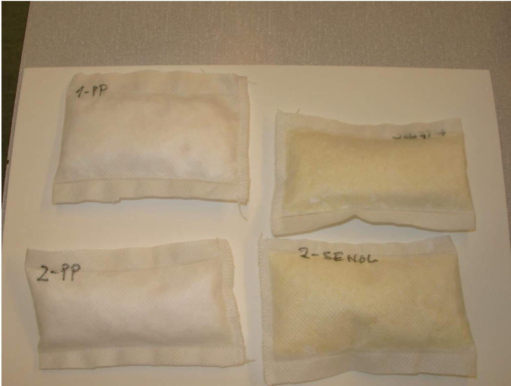
Figur 1. Påsar med PP-fibrer och polymerskum.
